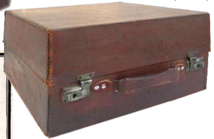
Burndept Vierröhren-Kofferradio für Mittel- und Langwellen, 1928 Geradeaus-Empfänger mit Rückkopplung, Lautsprecher eingebaut Grösse (B/H/T) 230 x 380 x 380 mm
